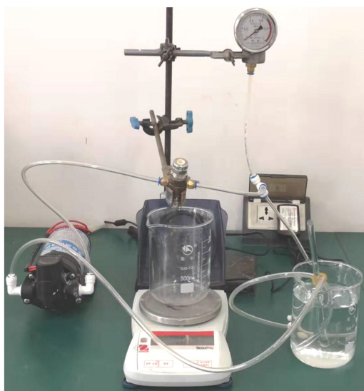
图1 交叉流式过滤系统实验装置照片
